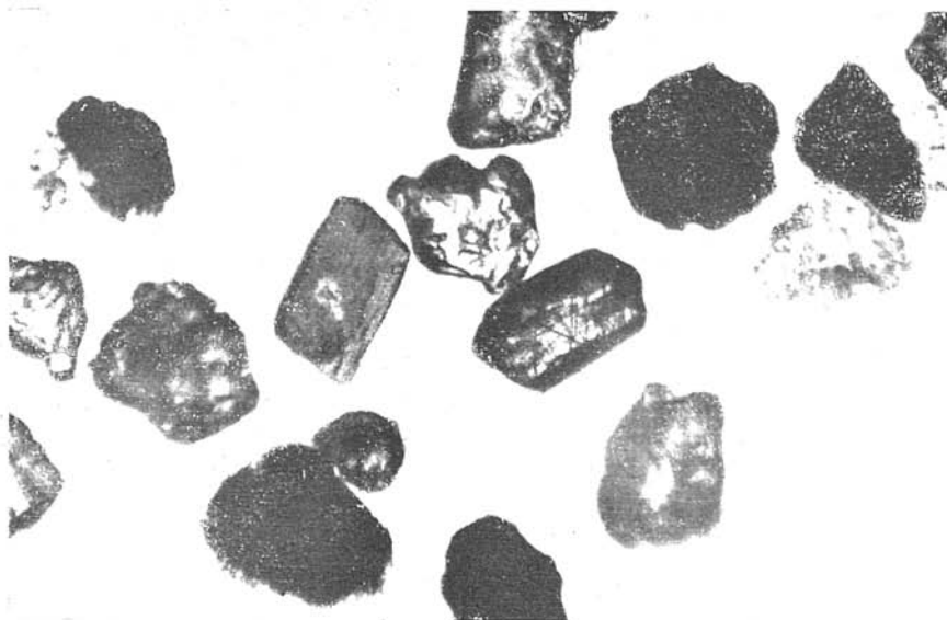
Obr. 1. Asociácia ťažkých minerálov z tortónskych pieskovcov okolia Vranova. V strede obrázku je rutil (priamky prebiehajúce priečne k obmedzeniu stĺpika prezrádajú poly-syntetické dvojčatenie podľa (101), stĺpcový turmalín a nepravidelne obmedzený granát. Zväčš. 138 \times . Mikrofoto Š. Buzek.
